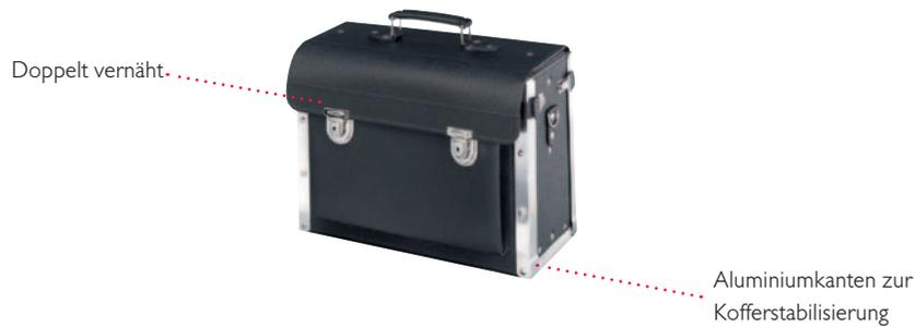
mit verzinkter, vernieteter Blechbodenwanne, abklappbare Vorderwand, Vorder- und Rückwand, Boden, Deckel und Seitenteile extra verstärkt, schwerer Tragegriff, 2 abschließbare Schlösser, seitliche Steckschlösser, Bodengleiter, seitliche Schlaufen für Schultertrageriemen, Innenseiten mit zahlreichen Werkzeugeinsteckfächern und verstellbaren Schlaufen, zusätzlich alle Außenkanten mit Alu-Winkeln verstärkt und mit abklappbarer Rückwand, herausnehmbarer Zwischenwand und Dokumenten-Vortasche
