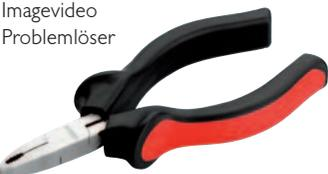
eingelegtes Gelenk, mit induktiv gehärteter Präzisionsschneide (ca. 58 HRC) für harten, mittelharten und weichen Draht. Gewölbte, horizontal- und vertikal-gezahnte Greifflächen, für alle selbstschneidenden oder metrischen Schrauben von M2 – M6
