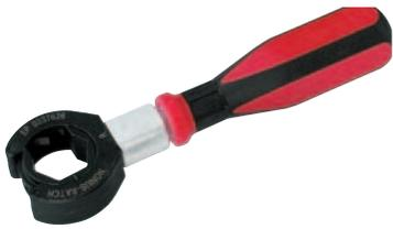
geschlitzter Ratschenkopf mit abnehmbarem Kunststoff-Handgriff, Schlüsselweite SW 20 zur Aufnahme aller nachfolgenden Schlüsseleinsätze, durch einfaches Umdrehen für Rechts- und Linkslauf, damit zum Anziehen und Lösen von Kabelverschraubungen geeignet.
