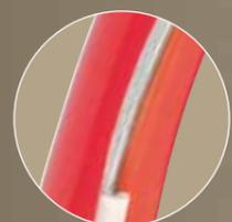
Griffhüllen mit zweifarbiger Kunststoff-Tauchisolation (wenn die rote Schicht beschädigt und die orangene Schicht sichtbar ist, ist keine Schutzfunktion mehr gegeben).
