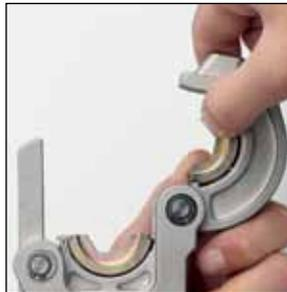
3. Presseinsatz in den unteren Teil des Presskopfes einsetzen
