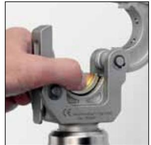
4. Presseinsatz in den oberen Teil des Presskopfes einsetzen
