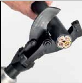
2. Schneidvorgang bei gedrücktem Startschalter durchführen. Der Schnitt ist korrekt beendet, wenn die Schneiden selbsttätig in die Grundstellung zurückfahren oder das Kabel vollständig getrennt wurde.
