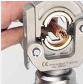
2. Kabelschuh auf Kabel schieben
