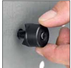
3. Stanzung bei gedrücktem Startschalter durchführen. Der Stanzvorgang ist korrekt beendet, wenn das Blech ohne Rückstand komplett gelocht wurde.
