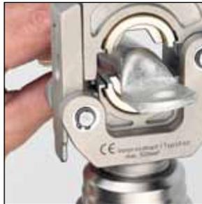
3. Verpressung bei gedrücktem Startschalter durchführen. Der Pressvorgang ist korrekt beendet, wenn die untere Pressbacke von alleine in die Grundstellung zurückfährt
