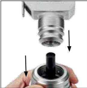
2. Korrekte Verriegelung des Kopfes prüfen. Die Verriegelungskante am Kopf muss durch den Arretiering überdeckt sein.
