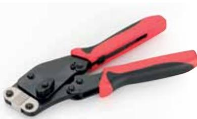
Unsere neue Vierkant-Frontpresszange FLEXI-CRIMP PRO deckt alle Aderendhülsen-Querschnitte von 0,5 mm<sup>2</sup> bis 16 mm<sup>2</sup> ab. Mittels des Umschalthebels ist der Querschnitt blitzschnell eingestellt.
