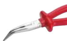
nach DIN ISO 5745, eingelegtes Gelenk, Backen 45° gewinkelt, induktiv gehärtete Präzisionsschneide (ca. 60 HRC), lange, flach-runde Backen (Flachrundzangen), gezahnte Greifflächen und gezahnte Aussparung (Brennerloch), mit Schneiden für harten und weichen Draht
