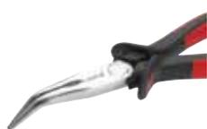
nach DIN ISO 5745, eingelegtes Gelenk, Backen 45° gewinkelt, induktiv gehärtete Präzisionsschneide (ca. 60 HRC), lange, flach-runde Backen (Flachrundzangen), gezahnte Greifflächen und gezahnte Aussparung (Brennerloch), mit Schneiden für harten und weichen Draht
