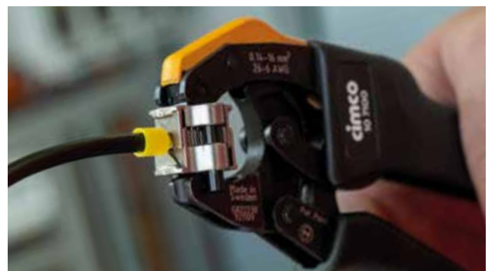
Frontale Zuführung der Aderendhülse.
